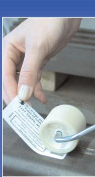
**5-> Códigos de barras legibles a pesar de que el cabezal de impresión por termotransferencia esté dañado**
